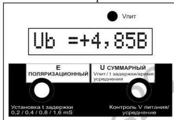
Рис.7.2 Индикация напряжения питания
