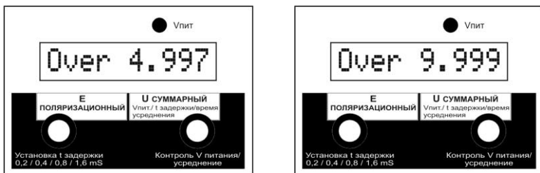
Рис.7.7 Индикация порога перегрузки
