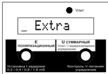
Рис.7.10 Индикация готовности результата экстраполяции
